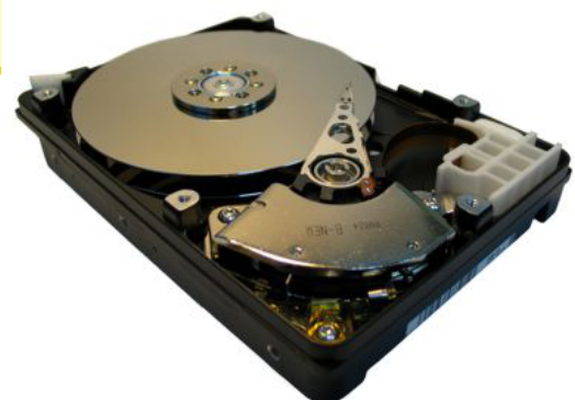
51. Ábra: Egy modern merevlemez belseje. A sajátodat ne akard megnézni, hogy ilyen-e, mert azzal tönkreteszed!
