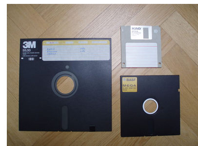
48. Ábra: Egy 8"-es, egy 5 1/4"-es (jobbra alul) és egy 3,5"-es hajlékony lemez
